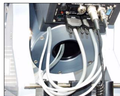
GM 4000 Kontrollpaneel und Kabelzuführung an der Stundenachse
